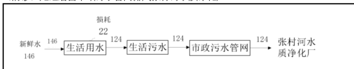
图 3-2 厂区水平衡图
