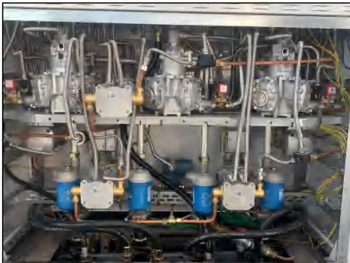
图 3-6 加油机机枪油气回收设施
